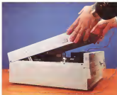
L'apertura del PCbit 286 è realizzata contemporaneamente ed scorre a compasso così che rende piuttosto agevole l'accesso all'interno per l'eventuale aggiunta di schede di espansione
